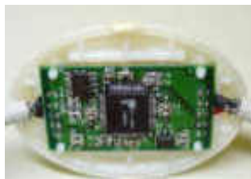
Gambar 2.1 Rangkaian elektronik pada kabel USB Bridge dengan chip PL 2501.
